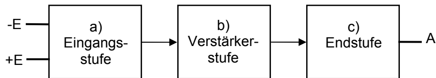
Abb. 1: Blockschaubild innerer Aufbau OpAmp
